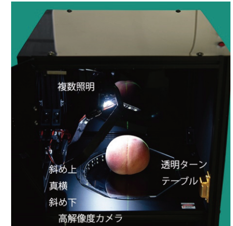
図2 モモシクイガ食入孔検出装置
