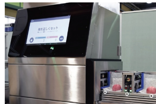
図3 モモシクイガ被害果検出装置
