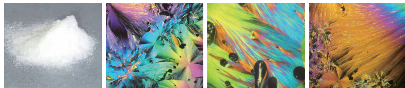
バニリン結晶 偏光を用いた観察結果1 偏光を用いた観察結果2 偏光を用いた観察結果3
