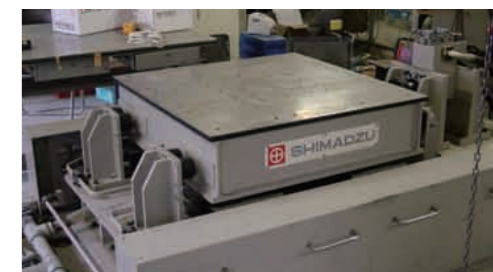
地震の揺れを再現する振動台
